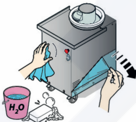
Rimozione pellicola di protezione
