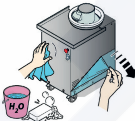
Rimozione pellicola di protezione
